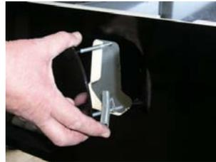
Mit einem passenden Gabelschlüssel die Muttern lösen und die Schellen entfernen.
