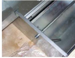
Die Ballsperre wie auf dem Bild im Ballkasten platzieren und die Führungsstange wieder durchführen.
