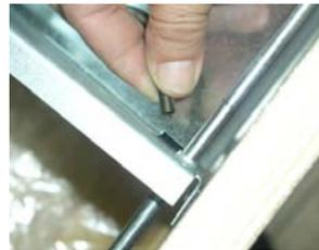
und die Rückzugsfeder eingehängt werden.
