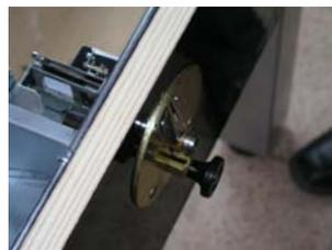
Hierbei muss darauf geachtet werden, dass der Münzeinwurfschlitz in der Waage ist, da die Funktionsfähigkeit bei schrägem Einbau gestört ist.
