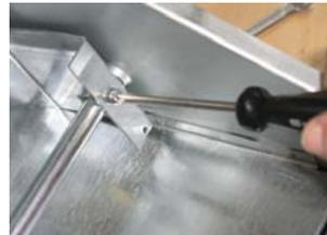
Hierbei muss noch darauf geachtet werden, dass der abgewinkelte Teil der Führungsstange zwischen den beiden Hebeln des Münzprüfers platziert wird. Jetzt müssen die Schellen nur noch verschraubt,
